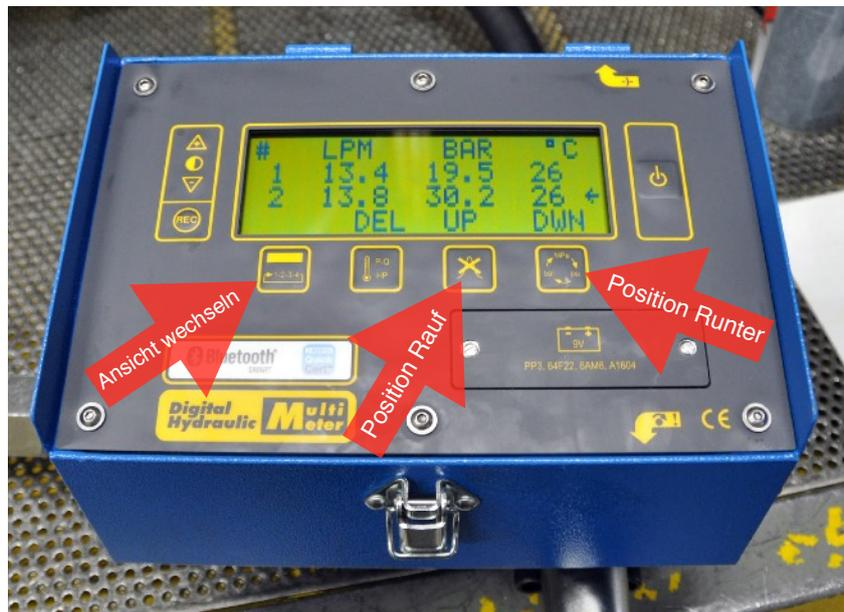
Mit der linken Taste kann zwischen den Bildschirmansichten gewechselt werden. Es gibt 4 verschiedene Display-Ansichten (vergleichen Sie dazu die Bedienungsanleitung von webtec). Wie im Bild oben sehen Sie in der Displayansicht 4 jetzt alle gespeicherten Datensätze.
