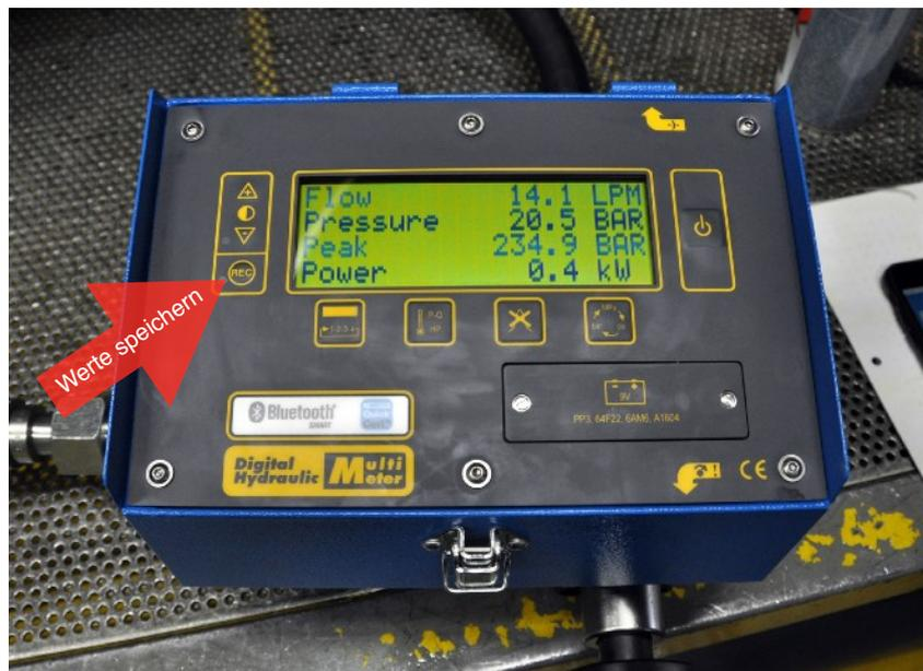
Starten Sie den Multimeter und schliessen Sie in an. Um nun die angezeigten Werte abzuspeichern betätigen Sie die REC-Taste (Aufzeichnen). Das Display bestätigt Ihnen den Vorgang mit „SAVED“ (Gespeichert).
